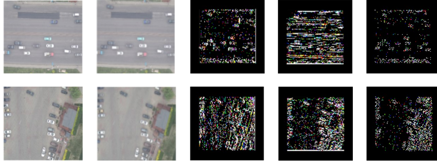
图 2 哈尔小波变换分解可见光图像可视化
